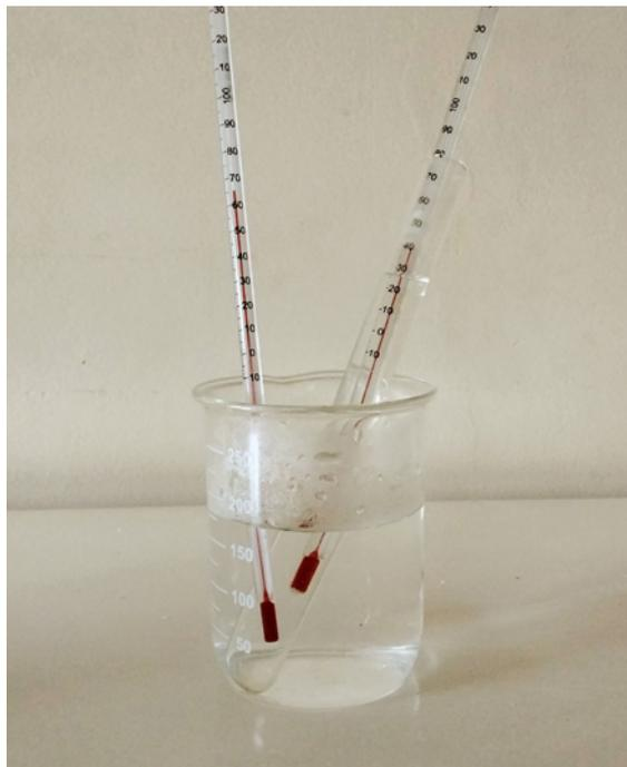
El agua del tubo que estaba a 20 °C aumenta su temperatura cuando recibe calor del agua del vaso que estaba a 60 °C.
