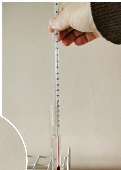
En la imagen se puede observar que el termómetro marca un valor de 40 °C. Esto significa que la temperatura del agua está entre 39 °C y 41 °C.
